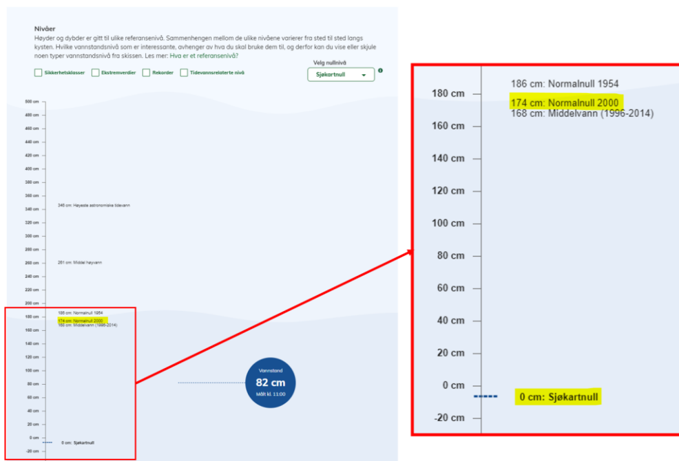
Figur 48: Bildet viser hvordan finne NN2000 relativt sjøkartnull for en gitt havn eller sted.
