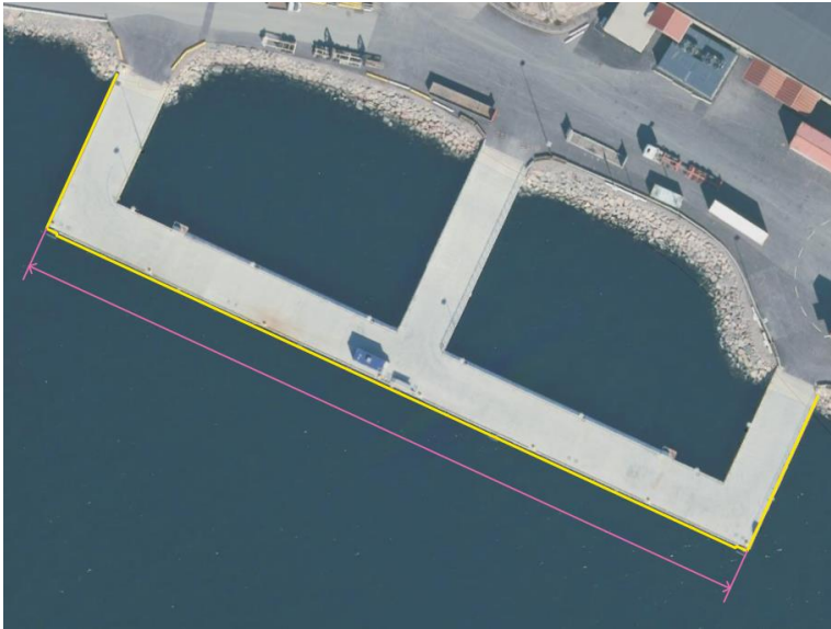
Figur 25: Eksempel på registrering av kaifront (gul linje). Lengden på kaien måles opp langs den delen av kaifronten som egner seg for anløp av skip (lilla linje). Høydereferanse: Topp (Norkart, 2020).
