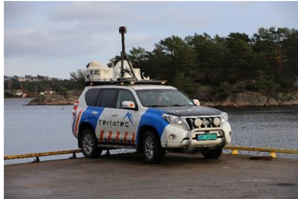
Figur 47: Innmåling med mobile mapping i Kristiansand havn (Foto: Norkart, 2020).
