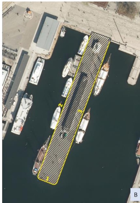
Figur 26: A. Kaien er ofte i praksis ikke en skarp 90 graders knekk, men kan ha en skråkant eller annen form for avrundning. Kaifronten måles inn på toppen, langs den ytterste linjen, før konstruksjonen skrår eller avrundes. Se linje inntegnet med rødt. B. Kaifront er ikke assosiert med kaiområde. Ett kaiområde registreres for én kai, selv om det er flere kai fronter langs kaien (nr. 1-3), som figuren viser. Kaiområde må avgrenses av KaiområdeGrense.
